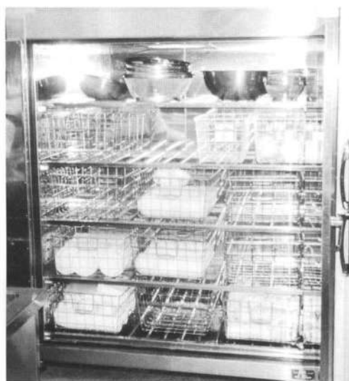
熱消毒保管庫
